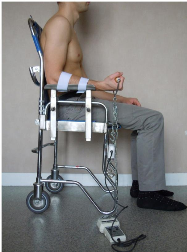
Figure 5. Le siège et le sujet en position lors de la mesure de force de flexion de poignet.
